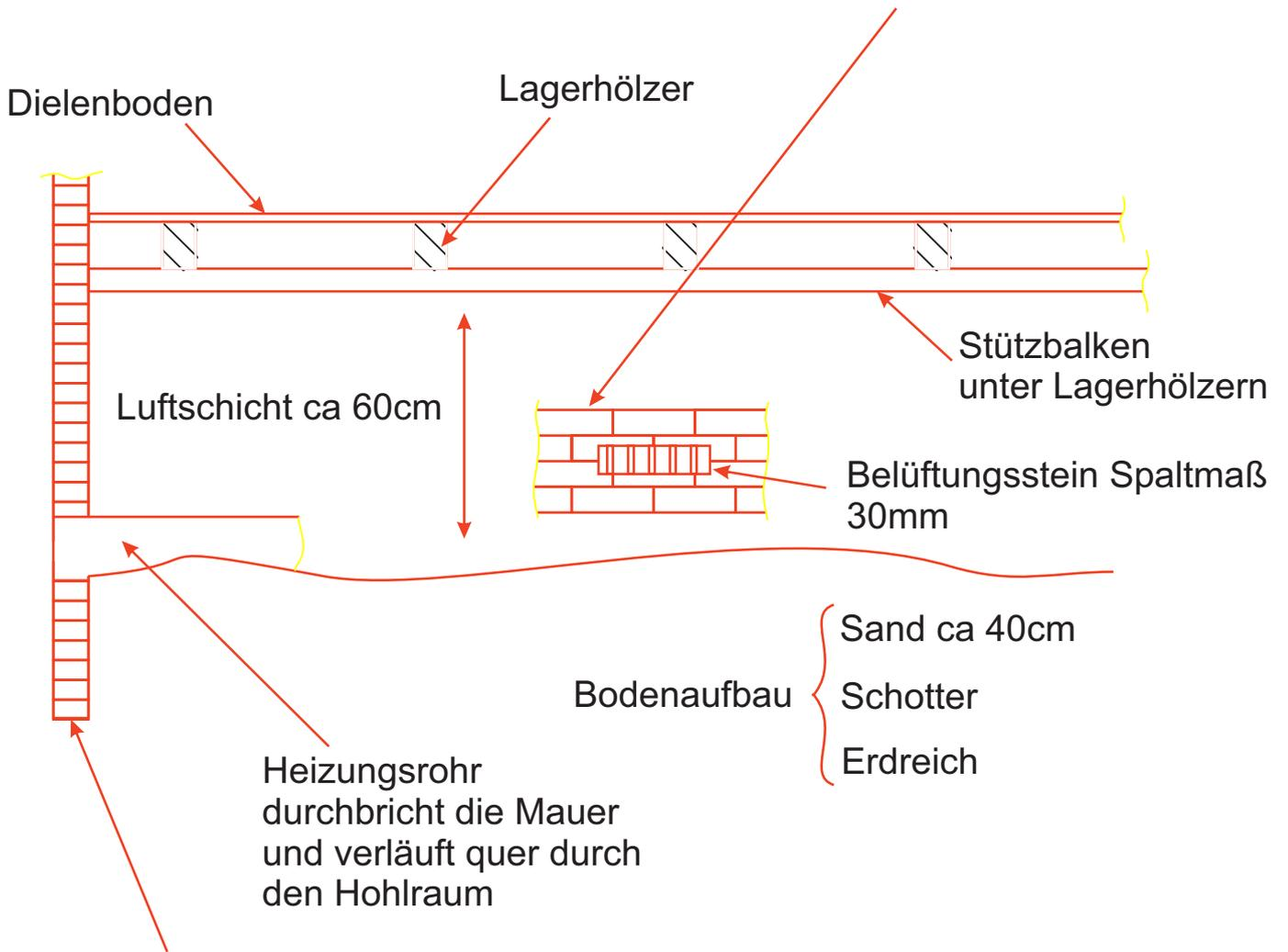
Aussenmauer steht im Bodenaufbau vermutlich auf Fundament ohne Feuchtigkeitssperre
