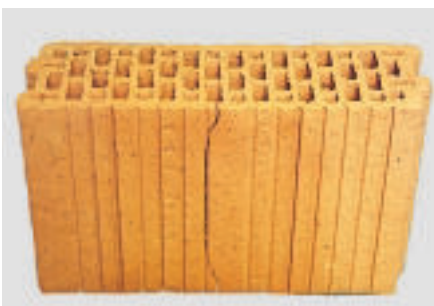
Bild 11 Ziegel mit Trocknungs- oder Brennrisse
